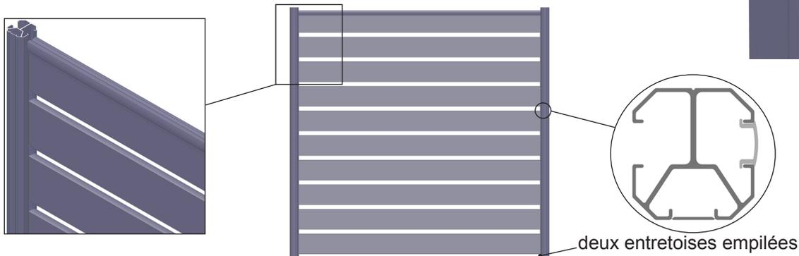
**ATTENTION** : Dans cette configuration, pour respecter une hauteur équivalente à une clôture pleine (1.8 m en pose scellée), il est nécessaire de rajouter une hauteur de deux entretoises empilées, en dessous de la première lame, soit 30 mm.
