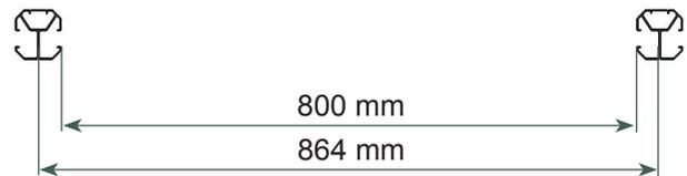
**Consiglio:** Per evitare qualsiasi errore riguardo all'interasse, si raccomanda di utilizzare la griglia come mascherina, inserendola per i due terzi dell'altezza, prima di fissare i paletti, oppure di fissare le basi.
